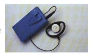
Im Einsatz sind zwei 1,5 V Mignonzellen - LR6. Bei Verwendung der empfohlenen Alkali-Batterien beträgt die Betriebsdauer ca. 200 Stunden.
